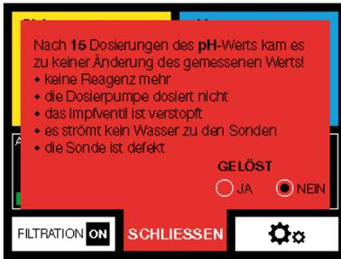
Nach **15/30** Dosierungen des pH-Wert-Mittels ohne Sondenreaktion wird diese Fehlermeldung gezeigt.
