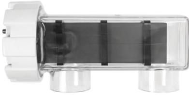
Die Elektrolysezelle TE 25 wird in die Druckwasserseite (Leitung zum Pool hin) nach dem Filterkessel eingebaut. Die Montage erfolgt in die Rohrleitung d=50 mittels Einkleben. Es wird empfohlen, die Elektrolysezelle in einem Bypass zu montieren und/oder mit Schraubverbindungen/Absperrventilen zu versehen. Damit ist ein einfacher Austausch später möglich.
