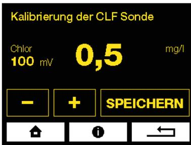
Kalibrieren Sie die Sonde erst nach dem **Durchmischen** des Schwimmbeckens und der **Stabilisierung** des Chlor- und pH Werts auf dem Display der ASIN AQUA.
