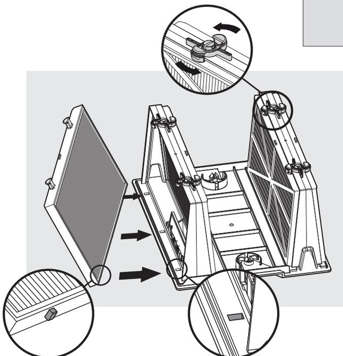
Setzen Sie den Filter ein, wobei die Plastikverstärkung nach außen schaut.
