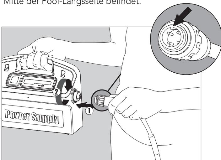
Verbinden Sie das Schwimmkabel mit dem Stromversorgungsgerät, indem Sie die Nut am Anschluss (1) ausrichten und den Stecker in das Stromversorgungsgerät stecken und dann im Uhrzeigersinn drehen (2).
