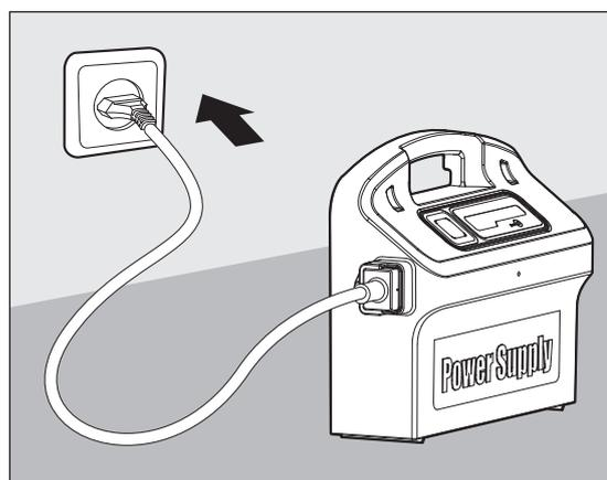
Stecken Sie das Stromversorgungsgerät in die Steckdose und stellen Sie es auf Position OFF.
